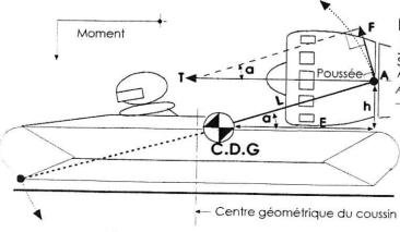
Détermination graphique du Moment Piqueur. CDG et A (Point d'action de la Poussée) sont positionnées par E et h. Joindre CDG à A. En A, tracer une perpendiculaire à L Sur cette perpendiculaire, porter la projection de A - T. = A-F. A-F représente la force F qui avec le levier L soulève l'arrière. Adopter pour le tracé: 10cm par mètre et 1 mm par kg de Poussée.
